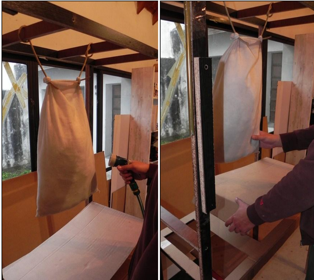
Limpieza general (decantación de agua sucia) + elevación de tapa decantadora
